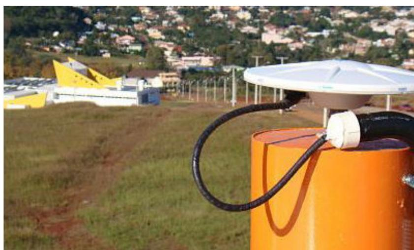
Por meio da estação, os dados são coletados e enviados via internet para um servidor RBMC instalado no Rio de Janeiro. Para acessá-los, o usuário necessita fazer um cadastro na página eletrônica da RBMC.
