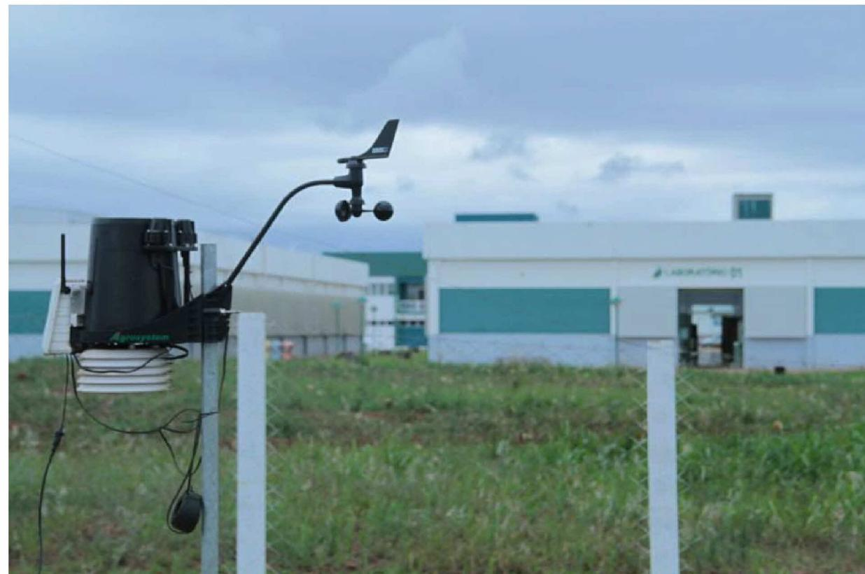
A quantidade da chuva em determinado período, a umidade relativa do ar, a velocidade e a direção do vento, índice ultravioleta, e claro, a temperatura do ambiente: todos esses dados são medidos pela Estação Meteorológica da Universidade Federal da Fronteira Sul (UFFS) Campus Cerro Largo. Ela foi implantada há cerca de um ano e passou por um período de testes e em local provisório.
